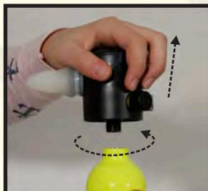
Scaricare l'aria, quindi ruotare l'erogatore in senso orario per svitarlo
